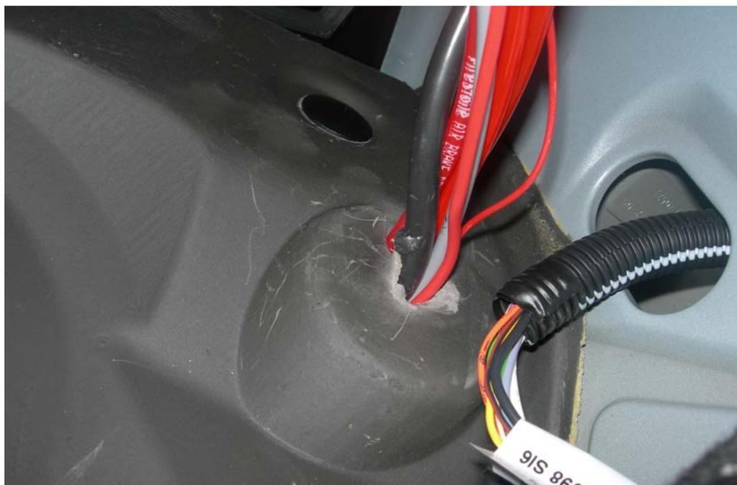
**Paso de los tubos neumáticos y los cables eléctricos de marcha del compresor desde la cabina al compartimento motor**
