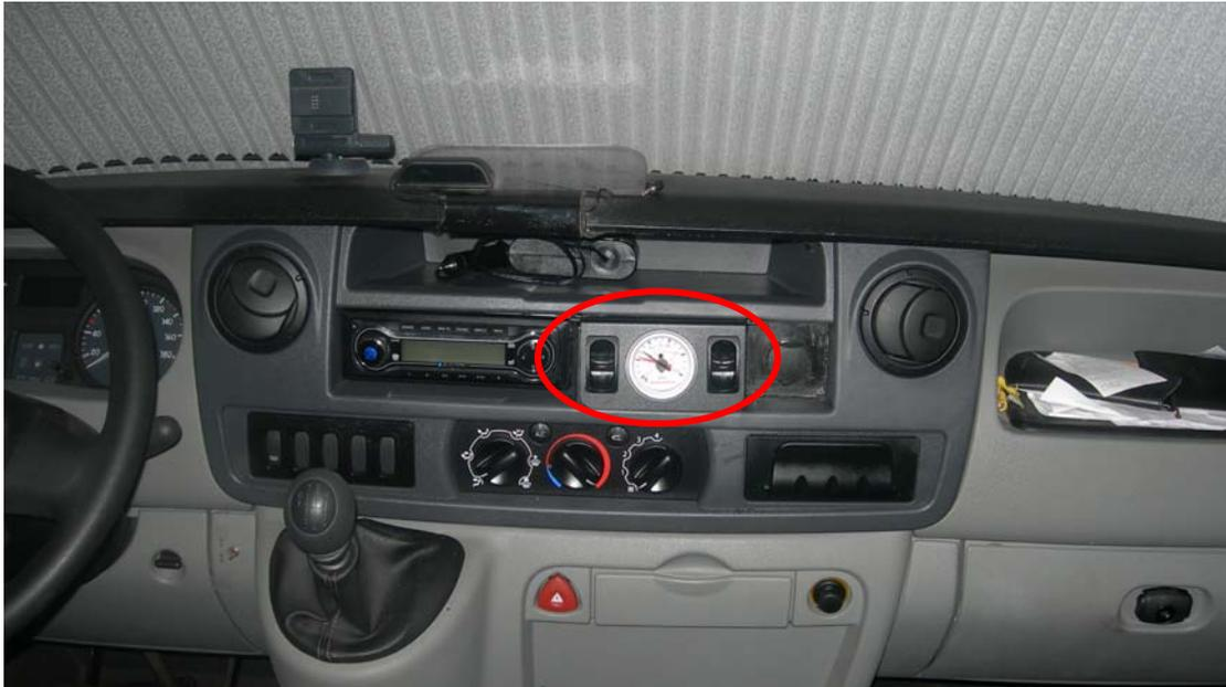
Vista del manómetro y válvulas de inflado en cabina
