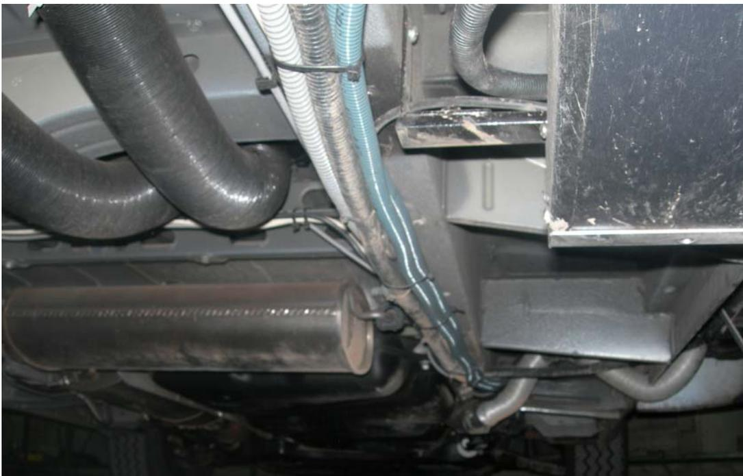
**Vista de la sujeción de los tubos neumáticos protegidos por un tubo eléctrico y sujetos por medio de bridas**
