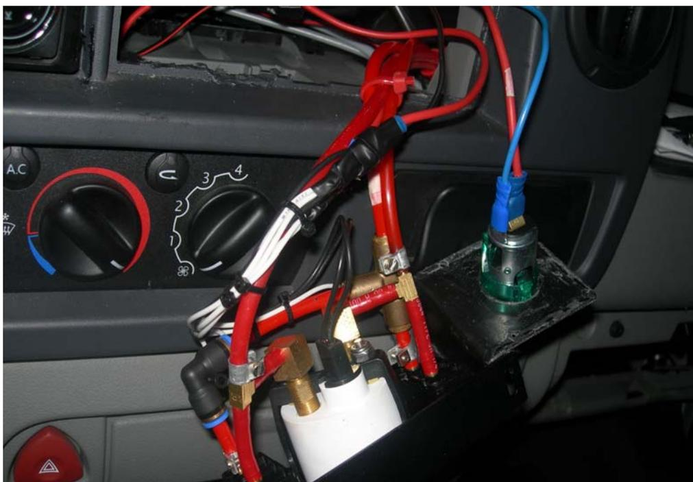
**Vista conexiones eléctricas y neumáticas en las válvulas de inflado**
